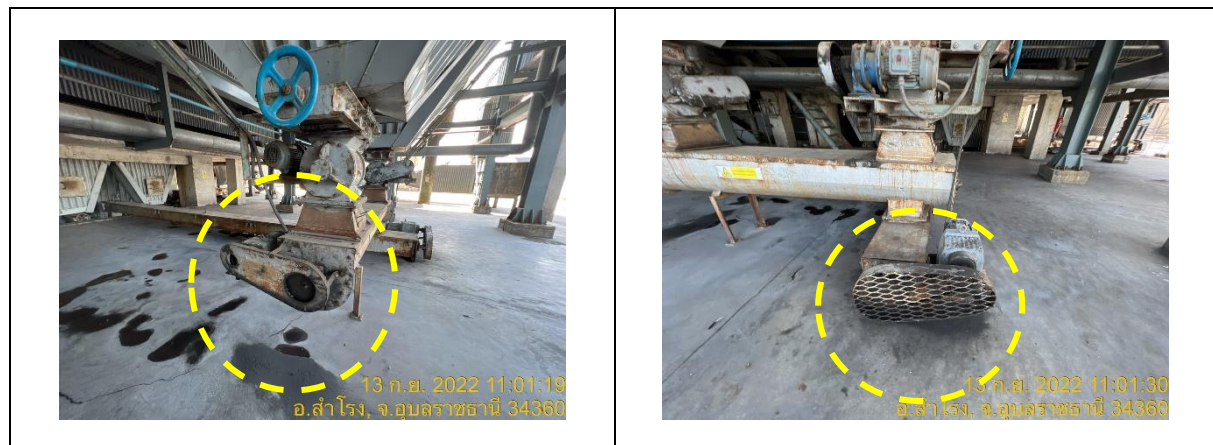
รูปที่ 76 การ์ดป้องกันอันตรายและปุ่มหยุดฉุกเฉิน
